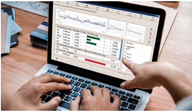
“评估”屏幕：带有轮廓、AD 曲线、Mr 曲线和公差监控的结果
