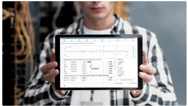
来自“RoughnessPlus”部分的内容。虚拟标尺可在轮廓字段中以交互方式设置 X 和 Z 方向上的距离
